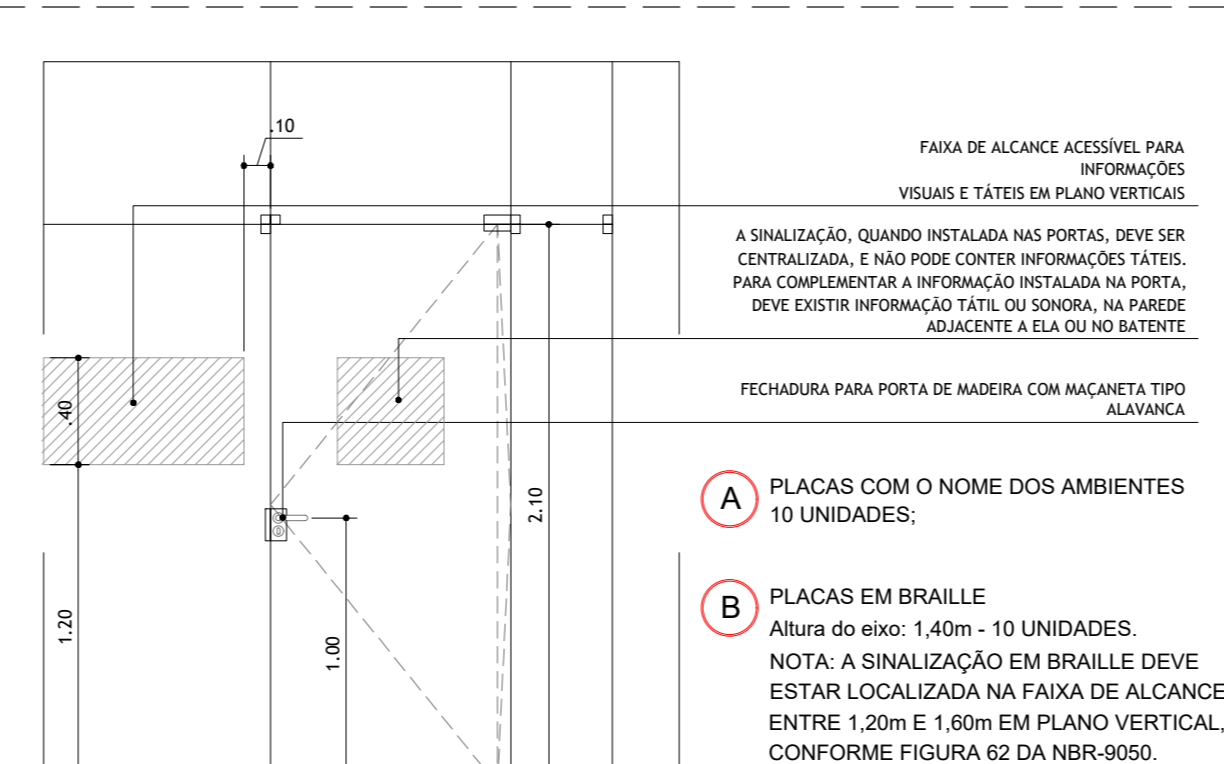
DETALHE 03: PLACAS DE SINALIZAÇÃO Sem Escala
